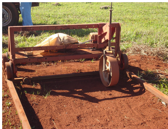
FIGURA 1. Roda compactadora acoplada ao trole.
